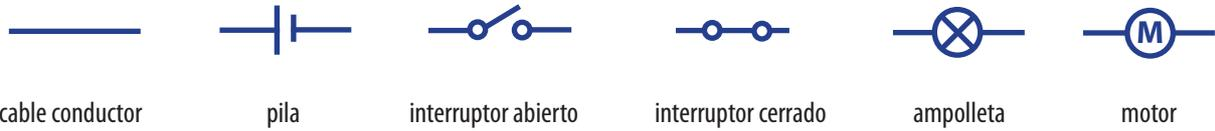
Si quieres representar un circuito, antes de construirlo, debes dibujar un esquema que incluya los principales componentes. A continuación se muestra un esquema de un circuito sencillo.
